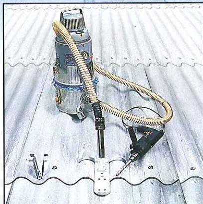
Perceuse équipée d'un foret à béton Ø14, Ø18
